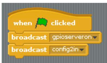
Impostare il pin GPIO 2 come input, usando il blocco broadcast e selezionando config2in
